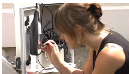
Installation et paramétrage d'une valise sonométrique par une technicienne de Bruitparif
